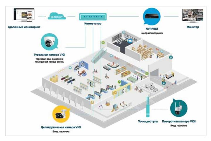
Рис. 6. Пример использования системы видеонаблюдения VIGI на базе супермаркета
