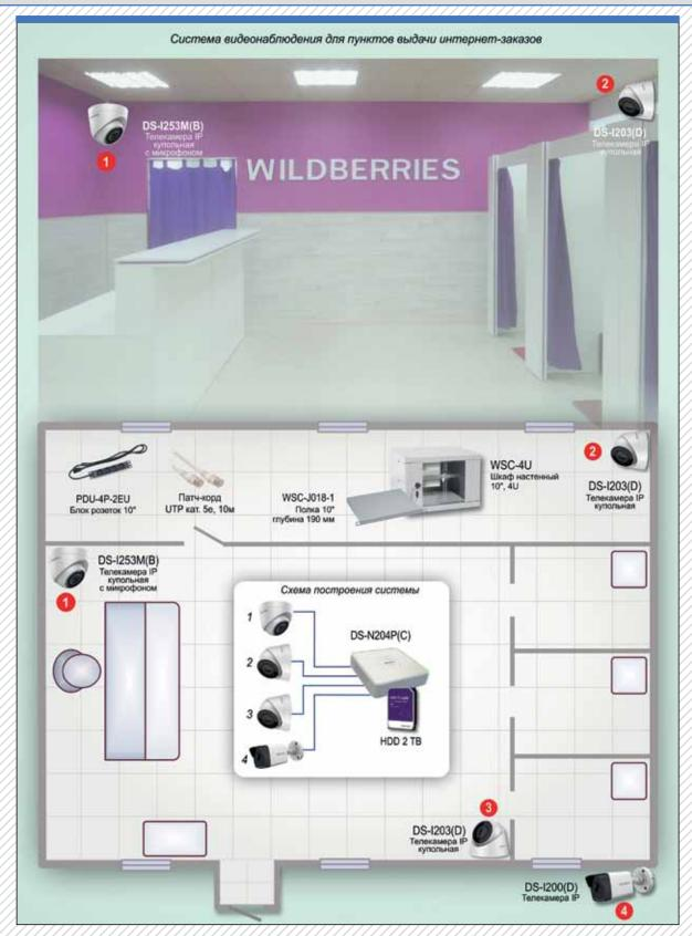
Схема 2. Схема построения системы видеонаблюдения для пунктов выдачи интернет-заказов
