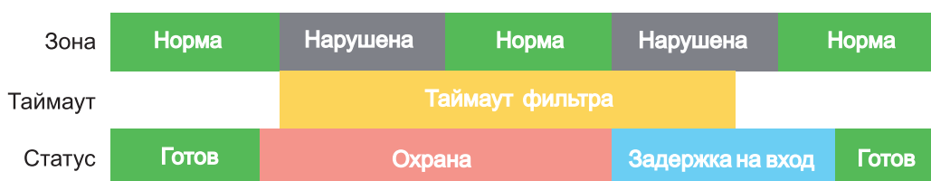
Рисунок 8. Начало задержки на вход при втором нарушении зоны Вход-выход.
