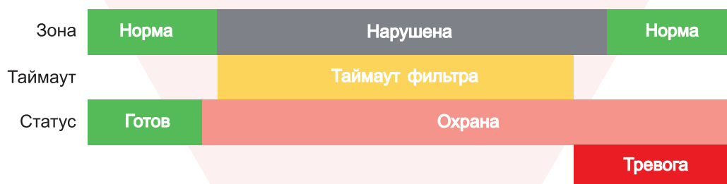
Рисунок 5. Тревога при нарушении по окончании таймаута.
