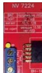
**NV 7224** Модуль контроля и защиты АКБ
