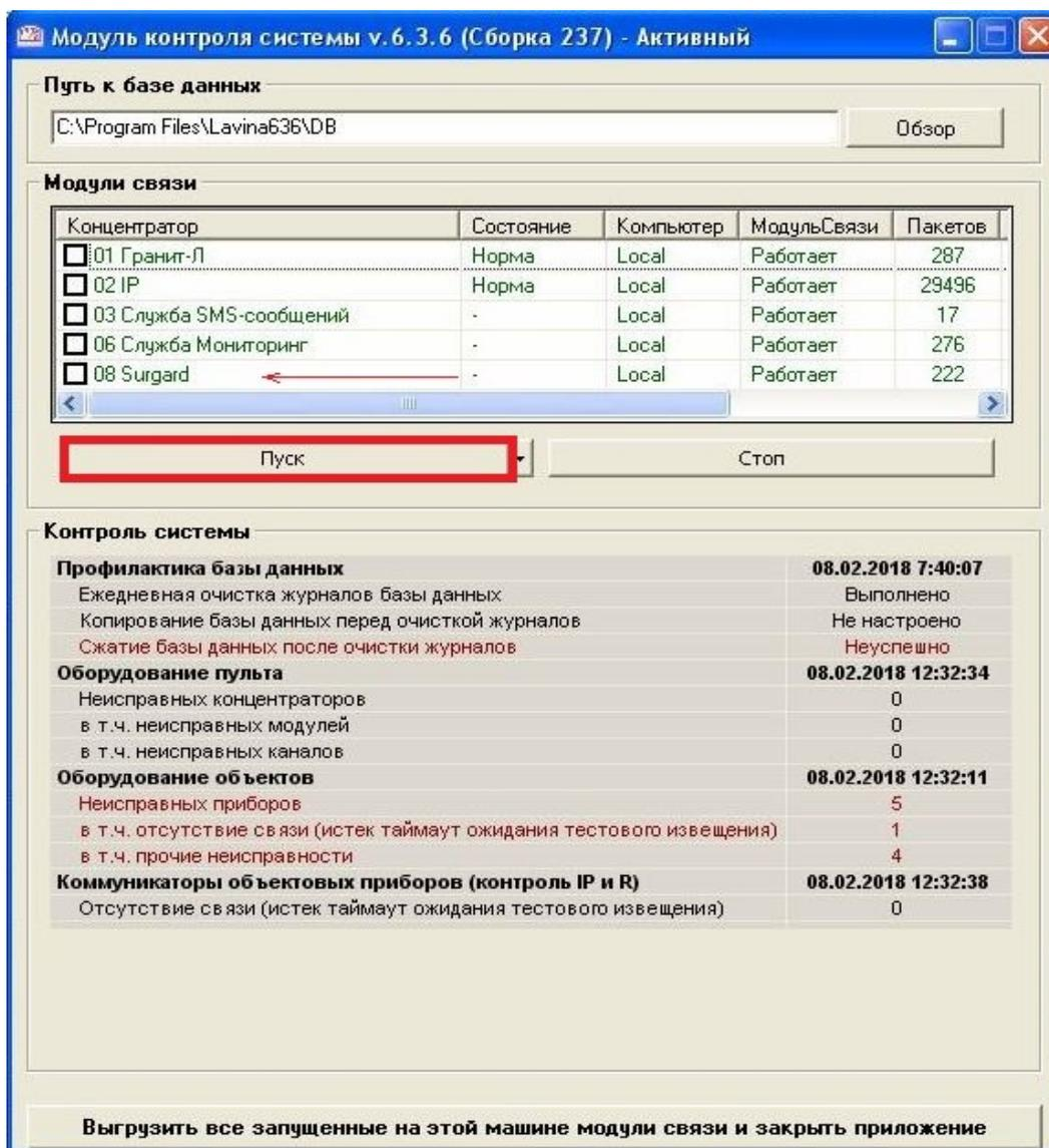
8. При добавлении приборов, отправляющих отчеты на NV GPRS Server, выбирать тип «Прибор Surgard». Код Contact\_Id должен соответствовать номеру объекта, запрограммированному в передатчик Navigard.
